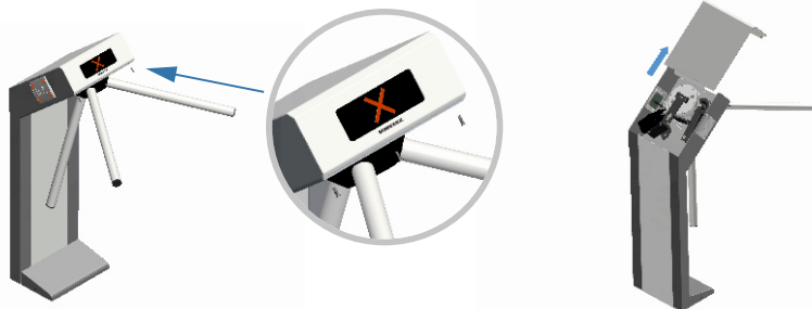
Рисунок 31. Демонтаж верхней крышки
